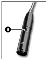
Abb. 1a: Phantomspannungsadapter mit Bassabschwächungsschalter (8)
