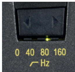
Abbildung 3: Wahlschalter für Tiefenabsenkung
