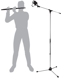
Abbildung 9: Abnahme der Querflöte mit nur einem Mikrofon
