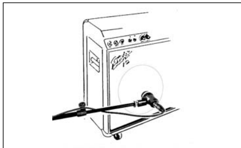
Abb. 3: Mikrofon-aufstellung für Gitarrenverstärker
