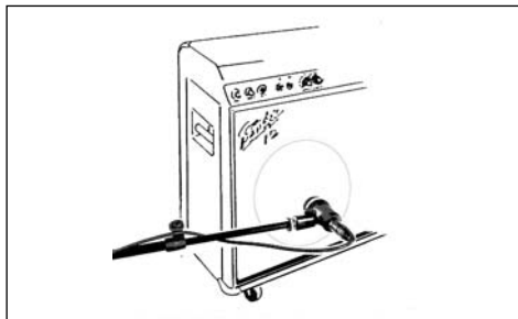
Fig. 3: Posizionamento del microfono per amplificatore per chitarra
