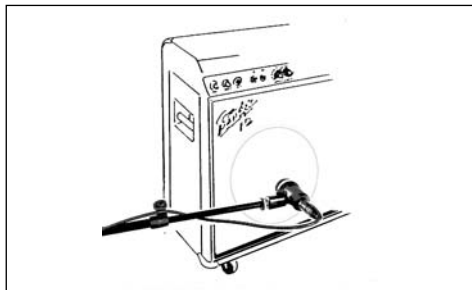
Fig. 3 : Position du micro pour amplis pour guitare
