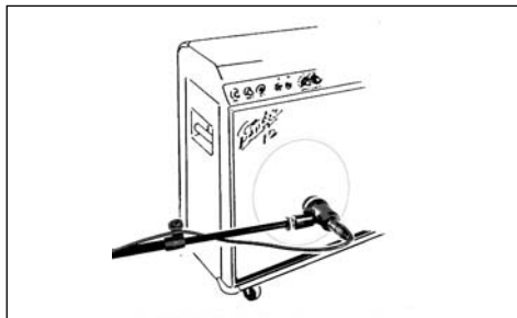
Fig. 3: Emplazamiento del micrófono para un amplificador de guitarra
